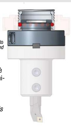
**Sistema bloccaggio utensili.** Il portautensili TG2000 è dotato di un attacco studiato, progettato e brevettato da Trevisan. La base di appoggio dell'attacco è molto ampia e questa caratteristica, sommata ad un ottimo bloccaggio, determina una rigidità assoluta tra utensile e carrello di tornitura.
