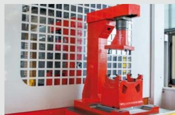
Attrezzature di staffaggio pezzi create su misura per avere un bloccaggio sicuro a fronte delle notevoli asportazioni.
